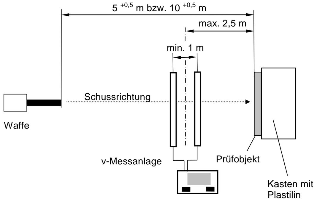
Abb. 1: Messaufbau 90°-Beschuss (Seitenansicht)
