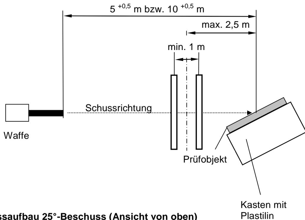
Abb. 2: Messaufbau 25°-Beschuss (Ansicht von oben)
