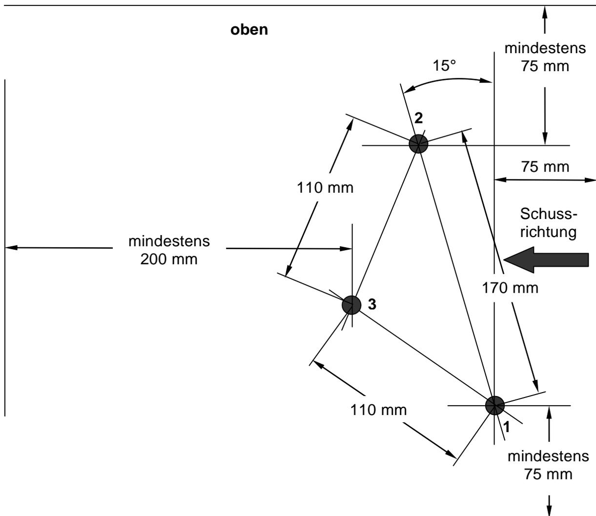
Zur Prüfung ist das Prüfmuster ggf. zu drehen, um die geforderten Mindestabstände einhalten zu können. Die Abgabe der Treffer hat entsprechend der Skizze und in der Reihenfolge der Nummerierung zu erfolgen.
