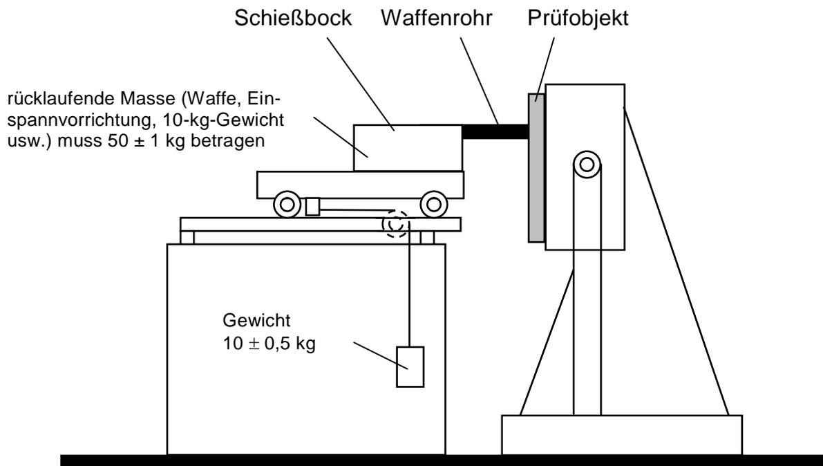
**Abb. 4: Prüfaufbau für aufgesetzten Schuss**
