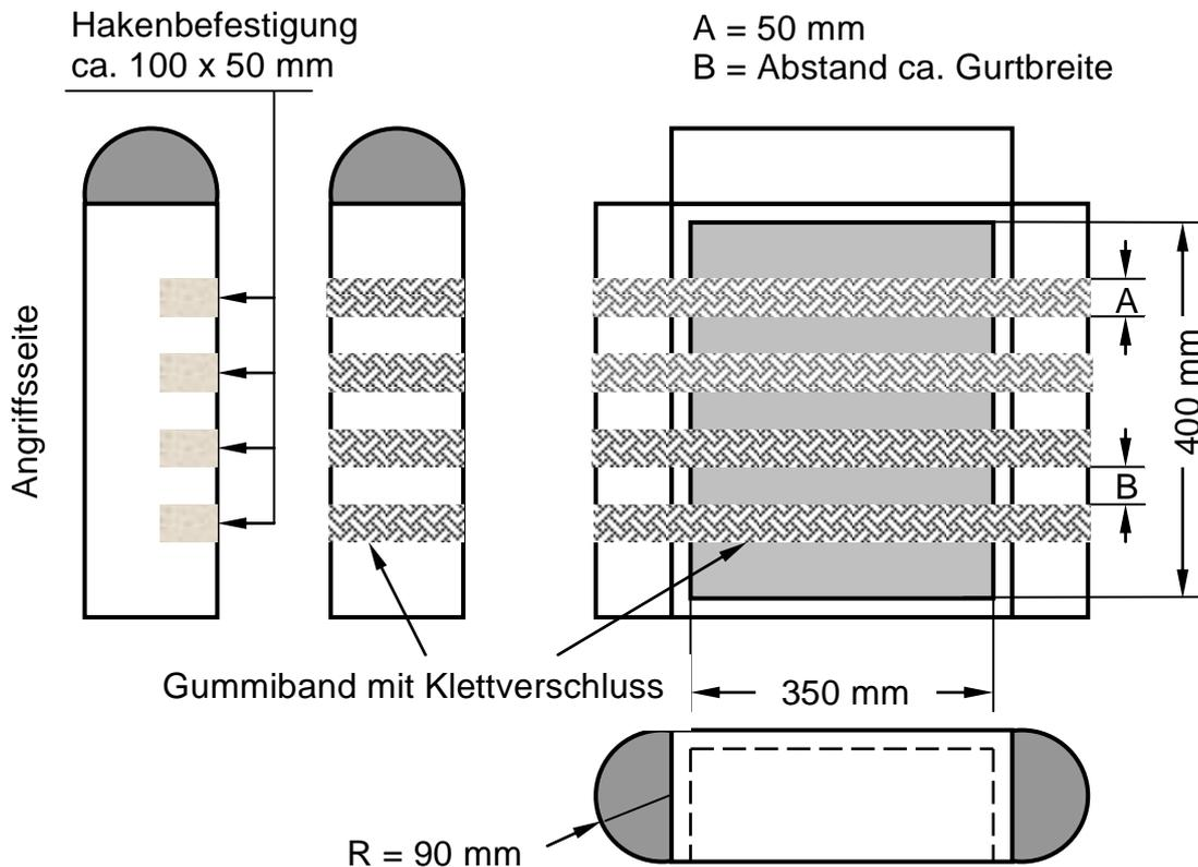
**Abb. 3: Kasten mit runden Schultern**
